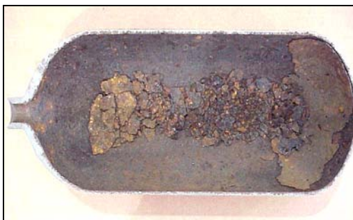
Corrosion sur une grande partie de la surface d'une bouteille de plongée
